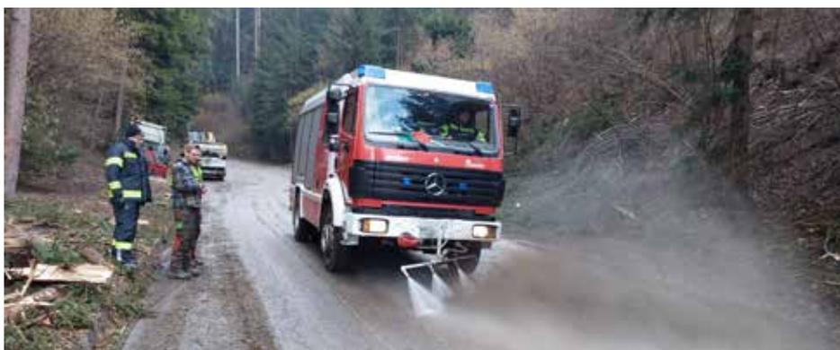
**Fahrbahnreinigung mit der Straßensprühanlage des Tanklöschfahrzeuges.**
